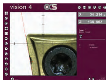
光源照明可檢視刀刃即時顯示量測結果
