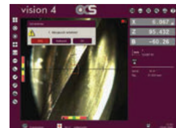
twincam：銑刀螺旋角及間距
